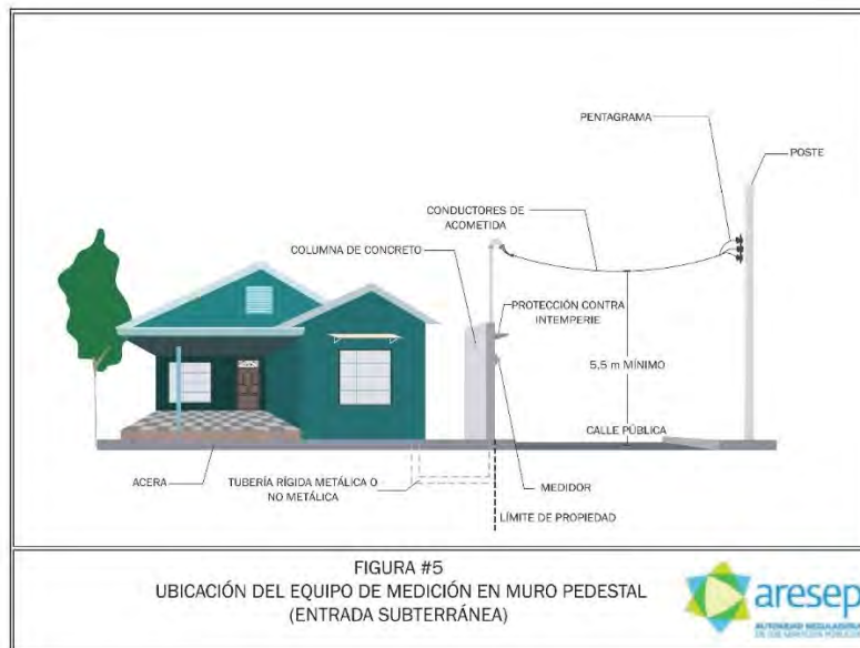
Figura 6. Acometida subterránea de baja tensión con columna de concreto para medidor (paso de calle).
