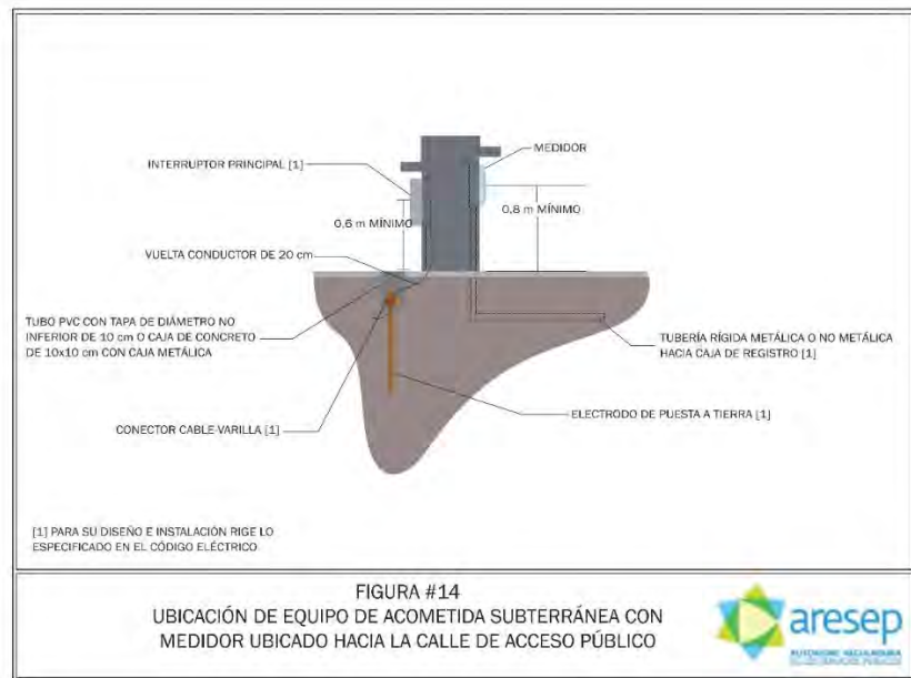
Figura 14. Ubicación de equipo de acometida subterránea con medidor ubicado hacia la calle de acceso público.
